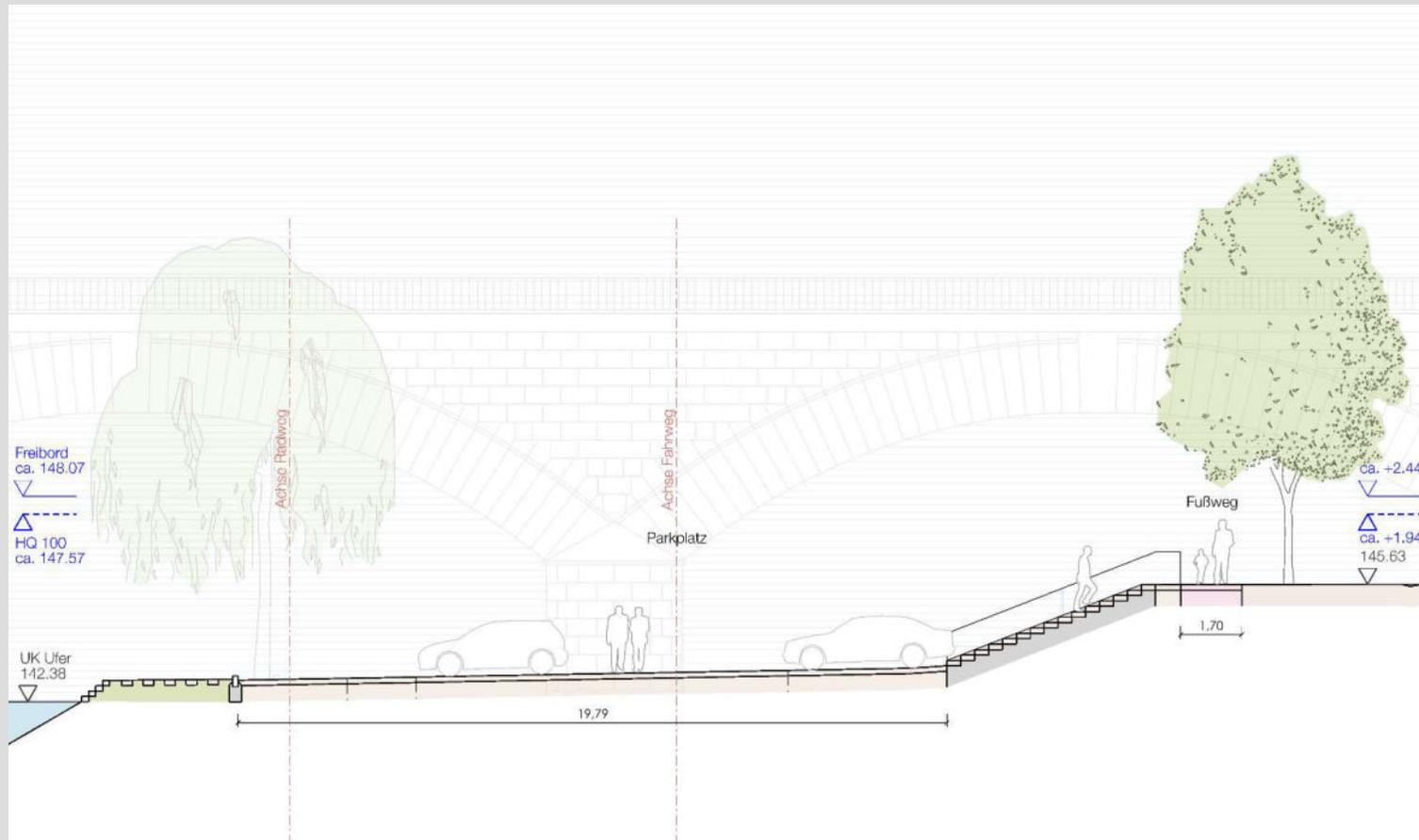
Regelschnitt –Treppenabgang und Zugang Ufer
